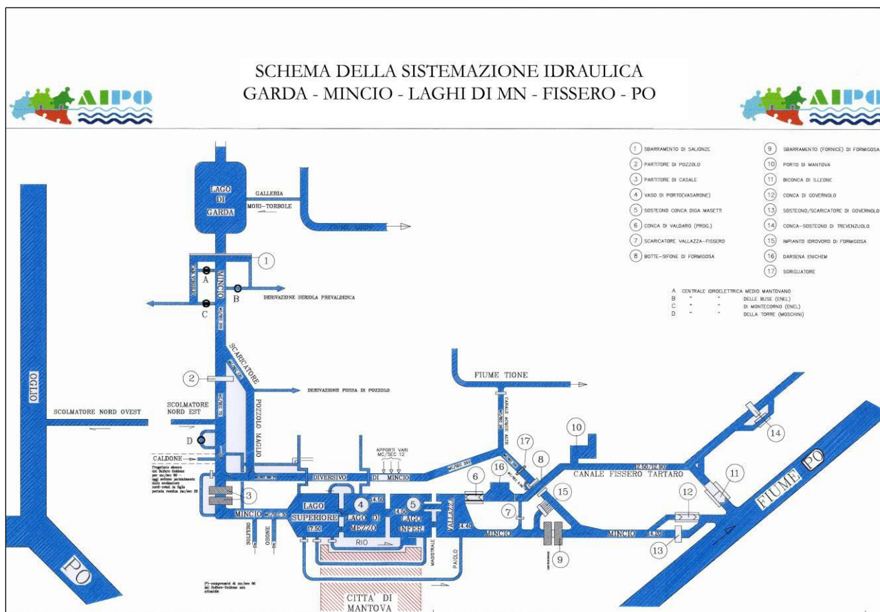
schema della sistemazione idraulica del sistema Garda – Mincio – Laghi di Mantova – Fissero – Po realizzato da AIPO
