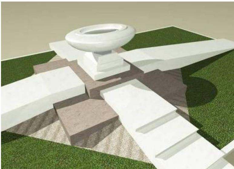
**Foto 4c.** Esempio tipologico. La parte fuori terra permette, quale alternativa allo spargimento delle ceneri, il versamento delle stesse nella ciotola centrale. Questa, collegata direttamente ad un vano interrato preposto permette di evitare l'eccessiva permanenza delle ceneri in superficie.
